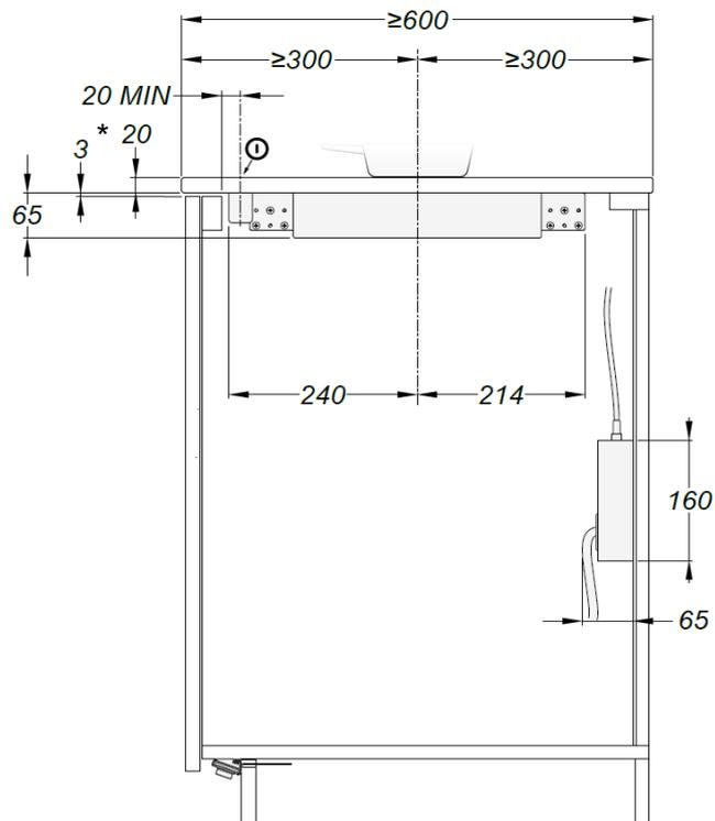
\* Ventilation: Pour un refroidissement suffisant, prévoyez une ouverture d'aération d'au moins 3mm juste sous le plan de travail sur toute la largeur de la taque de cuisson.
